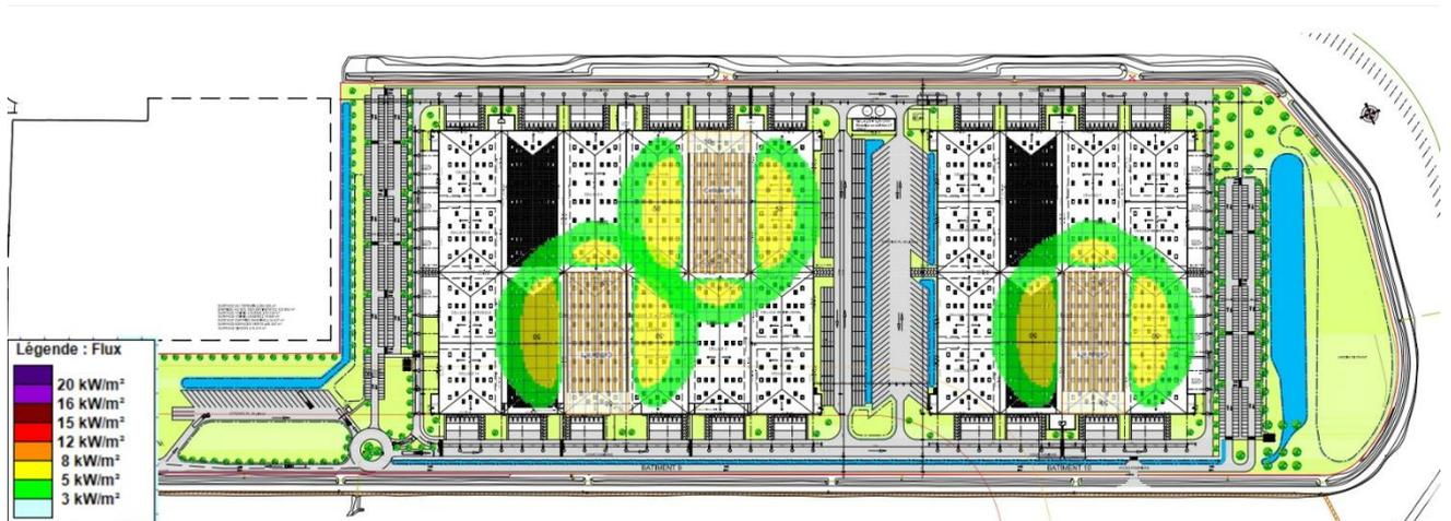
Figure 105 : Représentation cartographique des effets d'un incendie des cellules 3 et 11 du DC9 et 3 du DC10 – TH2-3
