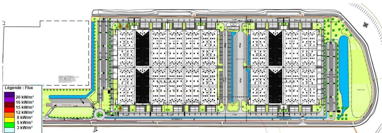
Figure 92 : Représentation cartographique des effets d'un incendie d'un camion à quai (TH1)
