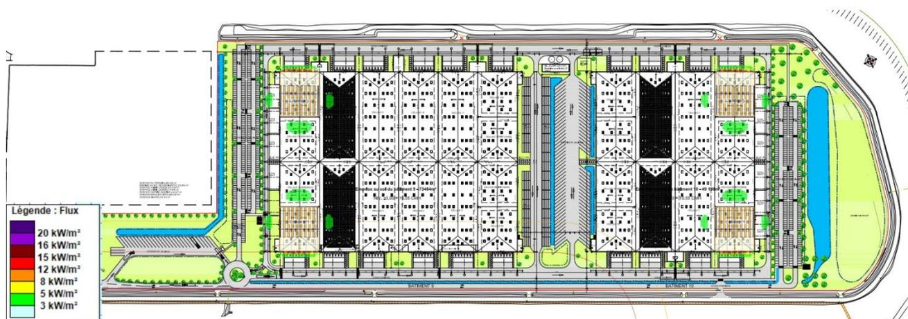
**Figure 110 : Représentation cartographique des effets d'un incendie des cellules 1A et 7A du DC9 et 4A et 8A du DC10 – TH2-5**
