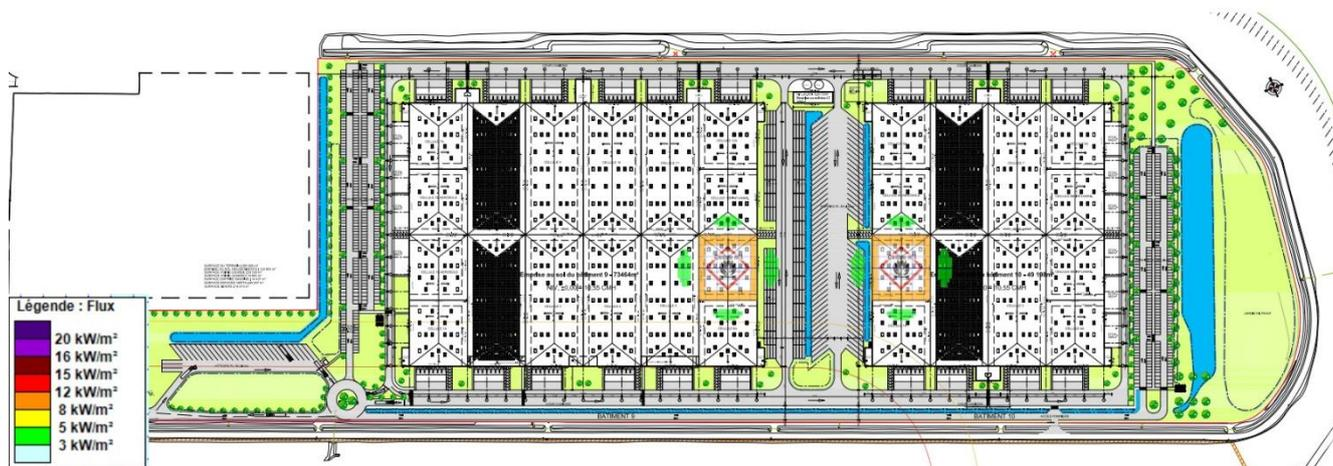
Figure 116 : Représentations cartographiques des effets d'un incendie d'une cellule de stockage de produits inflammables pour plusieurs positions (6B et 12B du DC9 et 4B et 8b du DC10) – TH4
