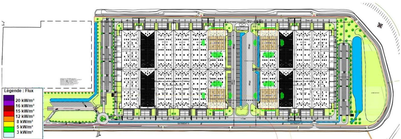
Figure 113 : Représentation cartographique des effets d'un incendie des cellules 6A et 12A du DC9 et 1A et 5A du DC10 – TH2-8
