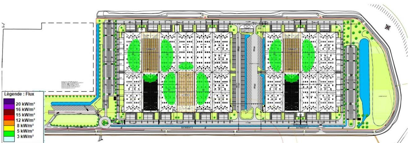
Figure 96 : Représentation cartographique des effets d'un incendie des cellules 4 et 8 du DC9 et 6 du DC10 – TH2-1
