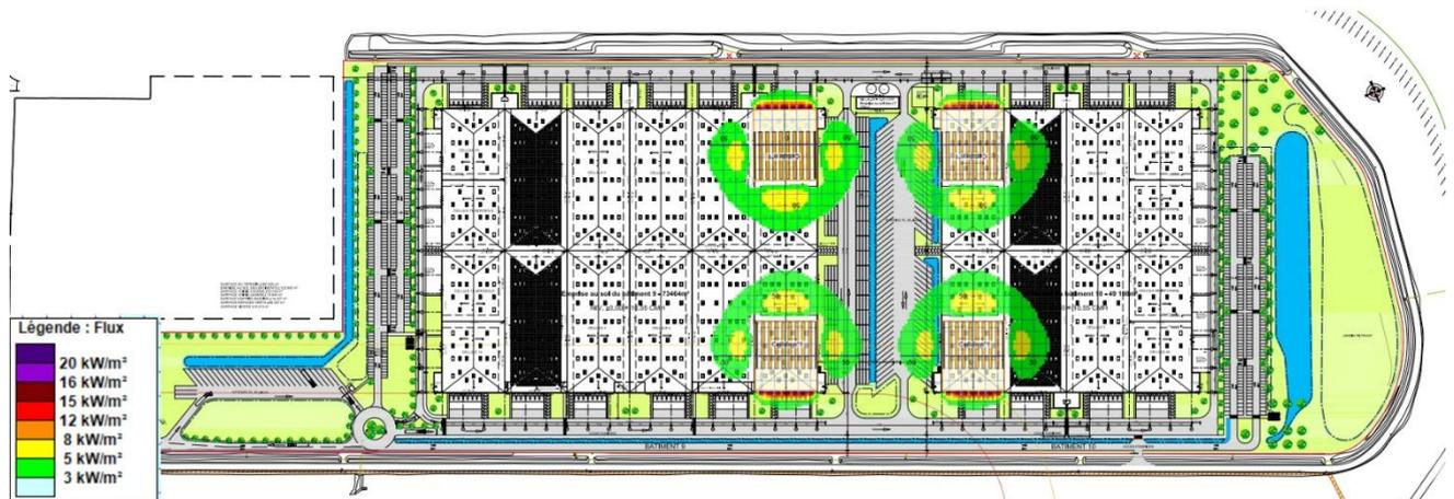
Figure 114 : Représentation cartographique des effets d'un incendie des cellules 6A et 12A du DC9 et 1A et 5A du DC10 – TH2-9
