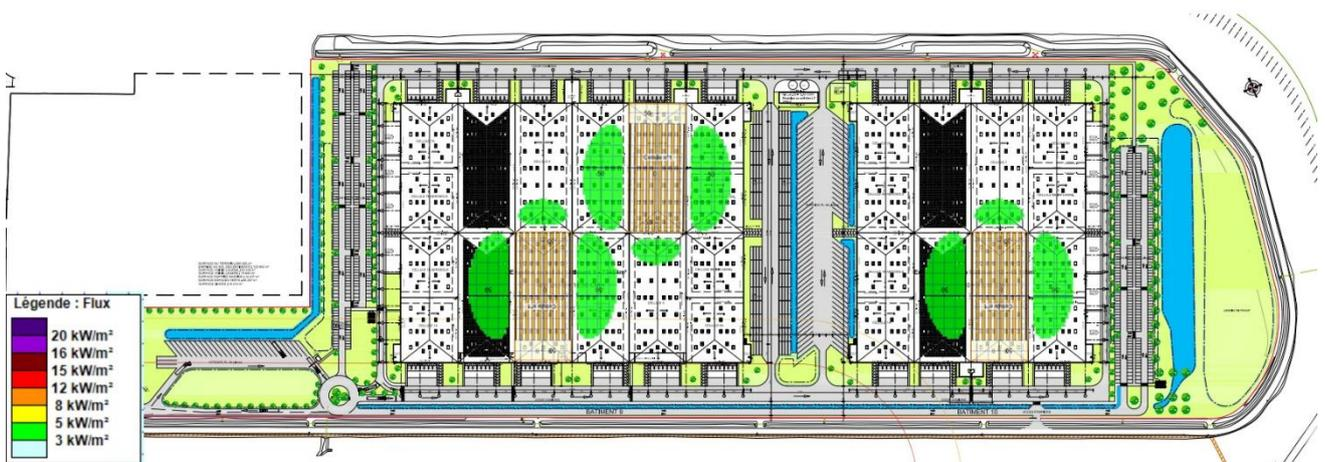
Figure 95 : Représentation cartographique des effets d'un incendie des cellules 3 et 11 du DC9 et 3 du DC10 – TH2-1
