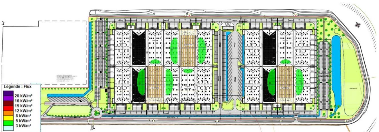
Figure 100 : Représentation cartographique des effets d'un incendie des cellules 3 et 11 du DC9 et 3 du DC10 – TH2-2
