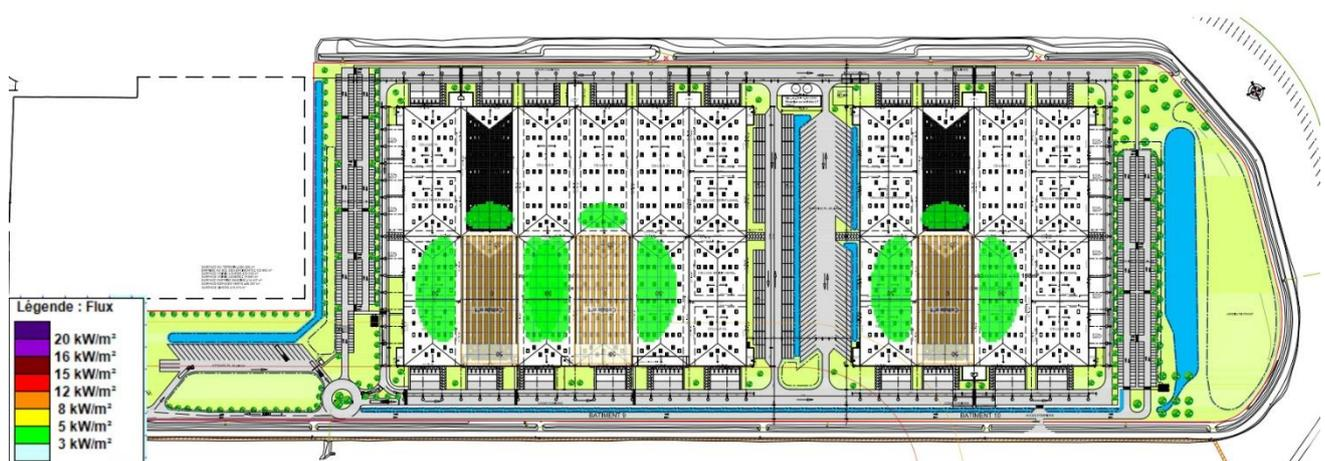
Figure 94 : Représentation cartographique des effets d'un incendie des cellules 2 et 5 du DC9 et 2 du DC10 – TH2-1
