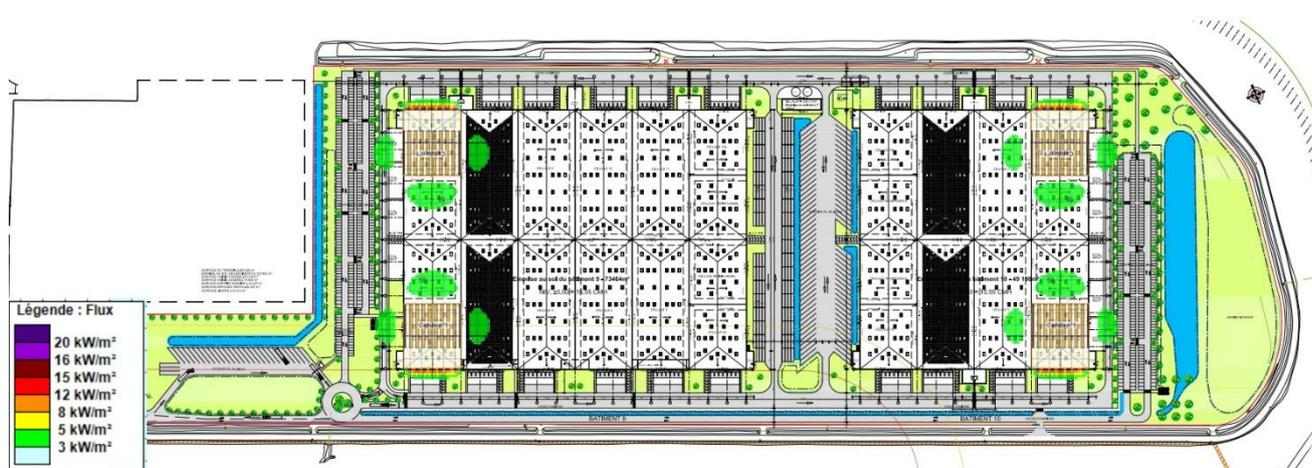
**Figure 109 : Représentation cartographique des effets d'un incendie des cellules 1A et 7A du DC9 et 4A et 8A du DC10 – TH2-4**
