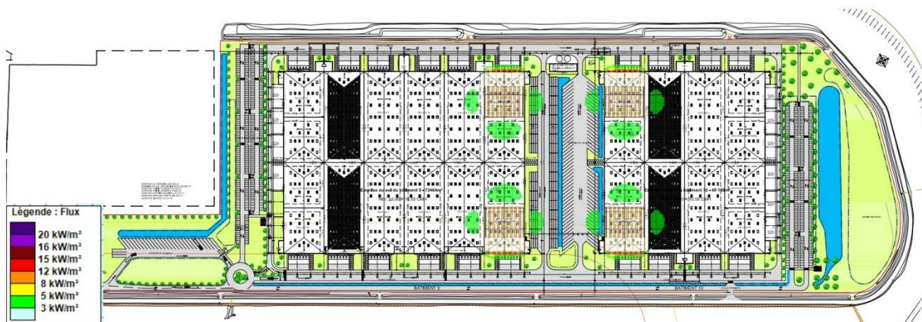
Figure 112 : Représentation cartographique des effets d'un incendie des cellules 6A et 12A du DC9 et 1A et 5A du DC10 – TH2-7
