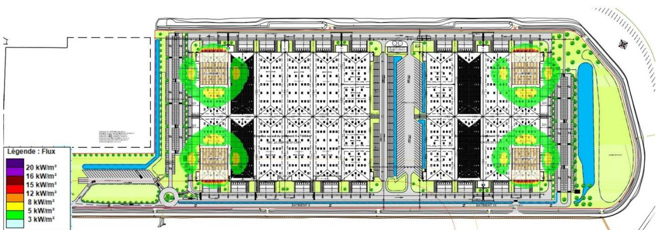
**Figure 111 : Représentation cartographique des effets d'un incendie des cellules 1A et 7A du DC9 et 4A et 8A du DC10 – TH2-6**
