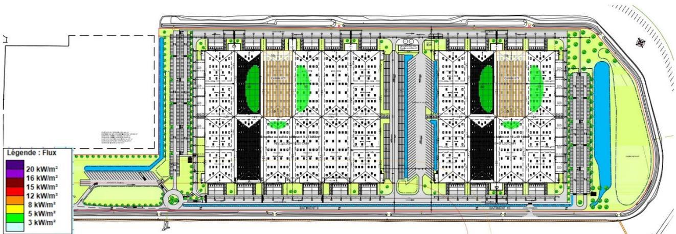
Figure 102 : Représentation cartographique des effets d'un incendie des cellules 9 du DC9 et 7 du DC10 – TH2-2
