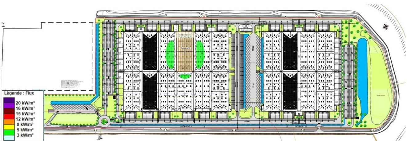
Figure 103 : Représentation cartographique des effets d'un incendie de la cellule 10 du DC9 – TH2-2
