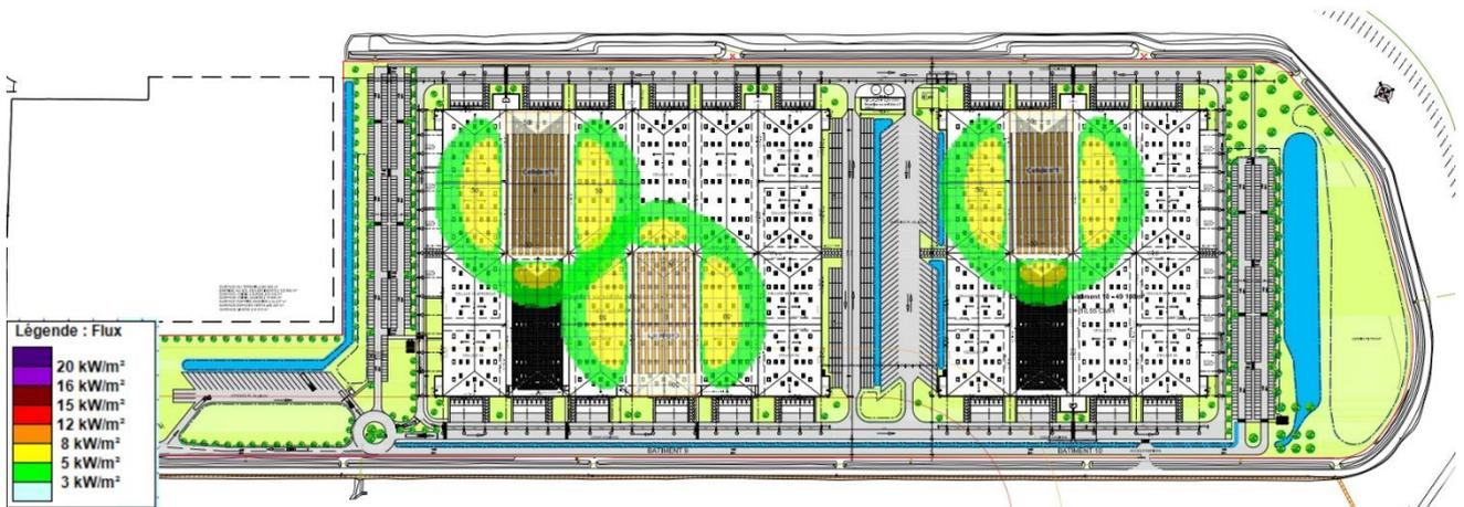
Figure 106 : Représentation cartographique des effets d'un incendie des cellules 4 et 8 du DC9 et 6 du DC10 – TH2-3
