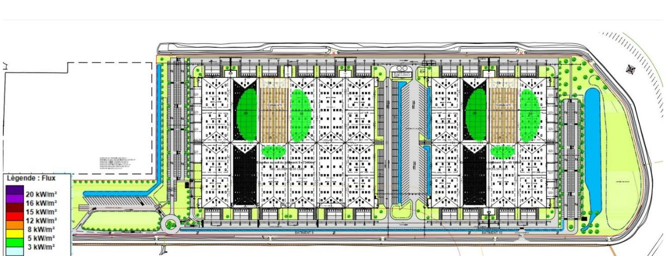
Figure 97 : Représentation cartographique des effets d'un incendie des cellules 9 du DC9 et 7 du DC10 – TH2-1
