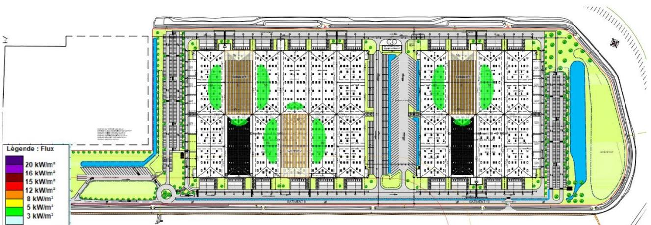
Figure 101 : Représentation cartographique des effets d'un incendie des cellules 4 et 8 du DC9 et 6 du DC10 – TH2-2
