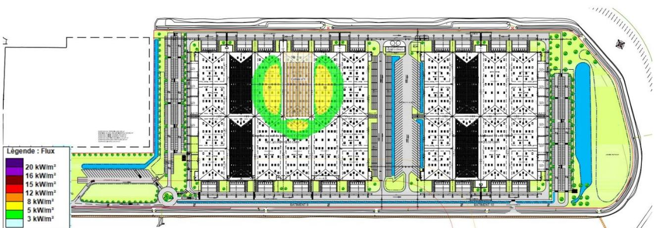
Figure 108 : Représentation cartographique des effets d'un incendie de la cellule 10 du DC9 – TH2-3
