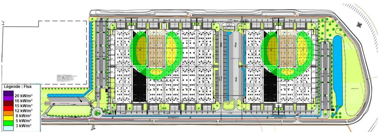
Figure 107 : Représentation cartographique des effets d'un incendie des cellules 9 du DC9 et 7 du DC10 – TH2-3
